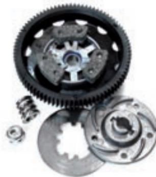
Leistungsspitzen absorbiert die Slipperkupplung zuverlässig
